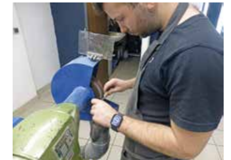
Les gestes précis et rapides du coutelier façonnant le manche du couteau.
