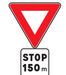
AB5 Arrêt à l'intersection. Signal avancé de l'AB4.
