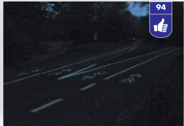
Peinture lumineuse à l'essai dans le département de l'Isère.
